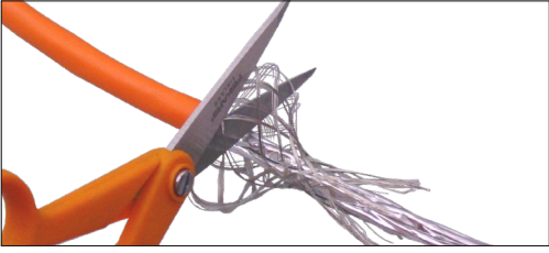
Geflechtschirm zurücklegen ... Fold braided shield backwards ...
